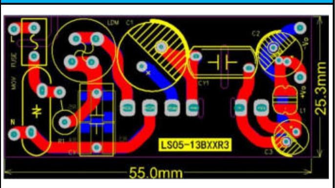
PCB layout(L\*W\*H: 48.5mm\*32.2mm\*23mm)
