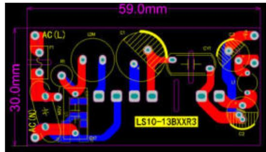
PCB design(L\*W\*H: 59.0mm\*30.0mm\*23mm)
